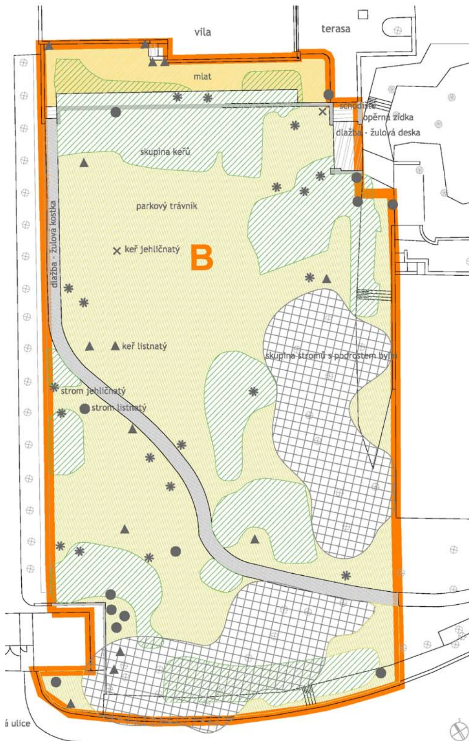
Obr. 38: Pasport části modelového objektu (tzv. Jižní parter zahrady vily Štiassní v Brně). Srovnáním s obr. 37 je zřejmé upřesnění polohopisu geodetického zaměření skupin keřů s ohledem na jejich detailní klasifikaci. Použité značky a výplně plošných prvků (šrafy, barva) nejsou standardizovány a jsou autorským řešením – v reálné dokumentaci jsou určeny legendou prvků. (FLORART, 2014)
